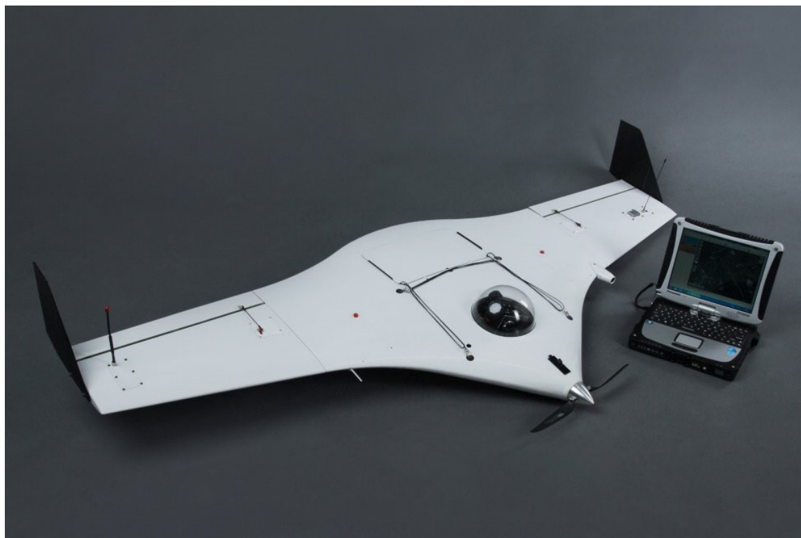
Рис. 5. Самолетный БПЛА типа «летающее крыло»
