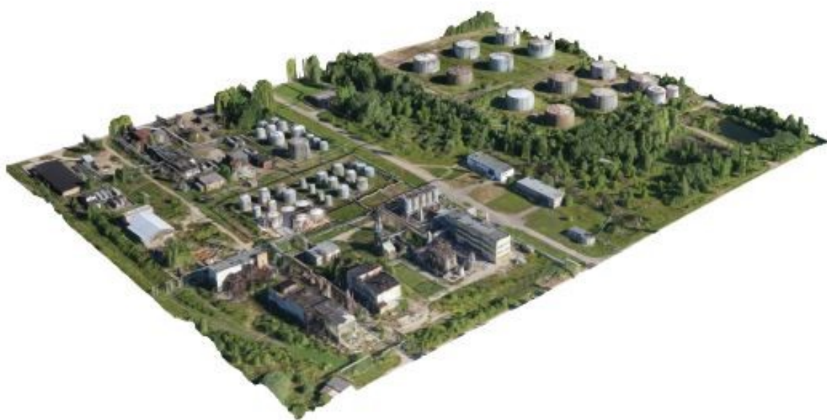
Рис. 12. Трехмерная модель, полученная в результате обработки данных с БПЛА
