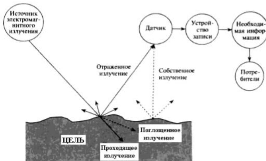
Рис. 2. Схема дистанционного зондирования
