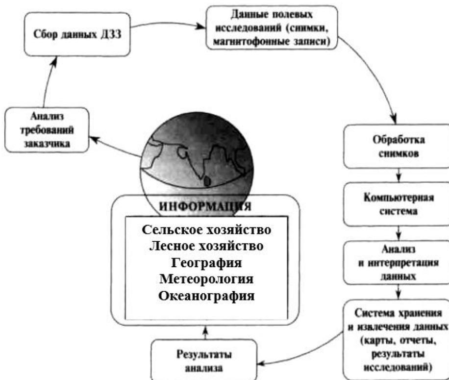
Рис. 3. Процесс получения и анализа данных дистанционного зондирования
