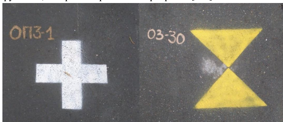
Рис. 2. Маркировка опознаков на асфальтированной поверхности
