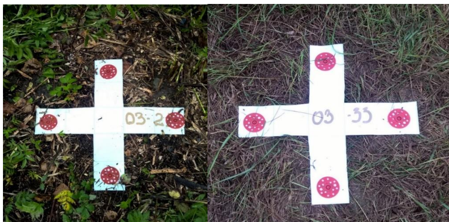
Рис. 3. Маркировка опознаков на поверхности грунта
