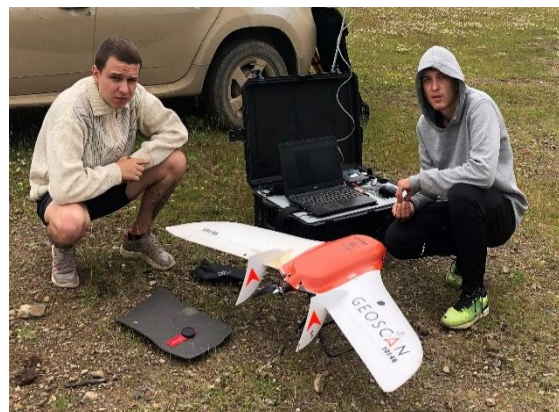
Рис. 1. Аэрофотосъемочный комплекс GeoScan-101
