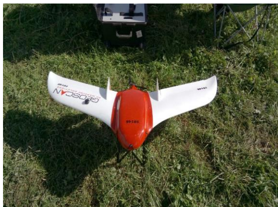
Рис. 1. Аэрофотосъемочный комплекс GeoScan-101
